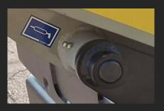
MD01 è stato progettato per durare nel tempo anche nelle condizioni più estreme, dato l'inserimento di boccole cementate con ragnatura interna sui perni di tutte le articolazioni, al fine di garantire un perfetto ingrassaggio e la riduzione degli sfregamenti e usura dei componenti installati, in modo da prolungarne la vita
